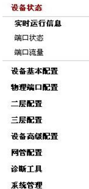
导航栏控制配置区中显示的内容。导航栏的内容以列表的形式显示，并按类别分组。缺省情况下列表定位在“实时运行信息”。如需进行某项配置，请先点击组名，待列表展开后点击子项。比如，如果需要查看当前的端口流量，请先点击“设备状态”，然后点击“端口流量”。
