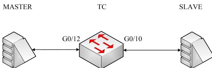
MASTER 为主时钟，为二层 PTP 设备。SLAVE 为从时钟，为三层 PTP 设备。TC 为支持透明时钟功能的交换机。主时钟与交换机的 G0/12 口相连，从时钟与交换机的端口 G0/10 相连。MASTER,TC,SLAVE 均工作于 P2P 模式。端口 G0/10、G0/12 通属于 VLAN1。
